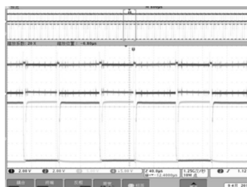
图4 光耦后端输出波形
