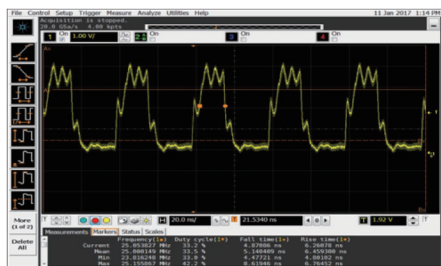
图4 接口模块T1故障时钟波形
