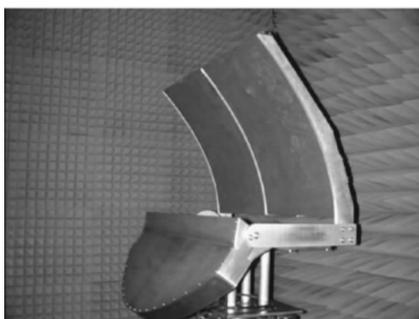
图2 金属反射面天线
