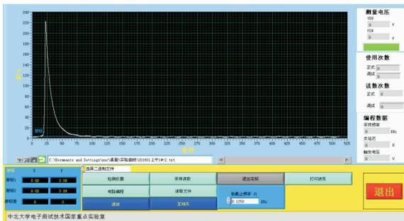
图8 测压仪所测得模拟膛压曲线
