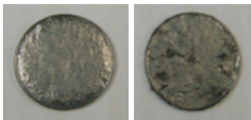
(a)由纯EG样品压制而成的圆片 (b)由碳纤维含量为1g的碳纤维/膨胀石墨复合材料压制而成的圆片
