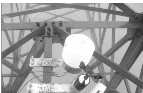
图 8 光纤光栅温湿度传感器安装现场图
