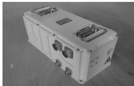
图4 双波长自由切换激光器工程样机
