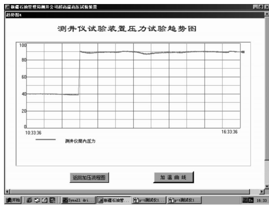
图1 测井仪试验装置压力测试趋势图
