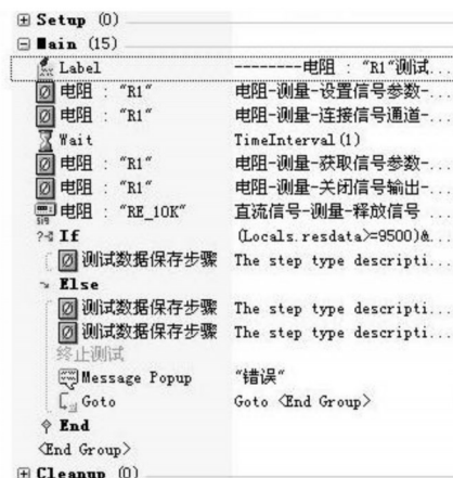
图3 识别电阻测试程序
