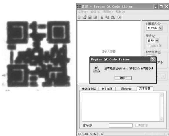
图 9 手机相机与小透镜距离为 25 mm 时的读取结果和解码结果
