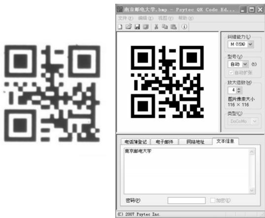
图 8 手机相机与小透镜距离为 19.54 mm 时的读取结果和解码结果
