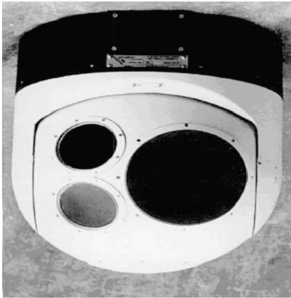
图1 RQ-1“捕食者”无人机上的光电平台
