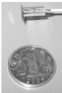
图5 MEMS低频声传感器传感头部
