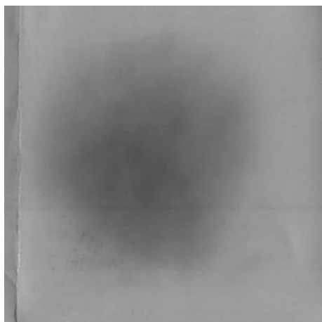
图7 90 m 激光靶面处光斑 ( d=35.6 \text{ mm} )
