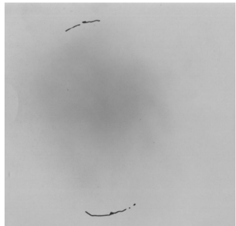
图8 107 m 激光靶面处光斑 ( d=40.5 \text{ mm} )
