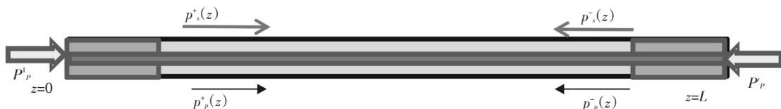
图2 端面泵浦光纤激光器示意图
