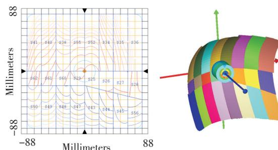
图4 自由曲面的分块和三维模型
