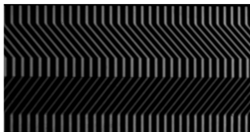
图8 经被测实物调制的 120^\circ 相位正弦条纹图像
