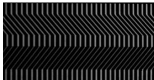
图7 经被测实物调制的 0^\circ 相位正弦条纹图像
