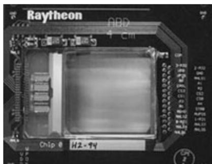
图4 雷声公司制作的一维液晶光学相控阵芯片
