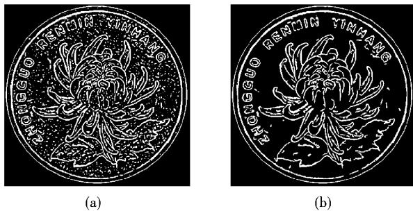
图 2 纹理图像的提取及噪声消除
