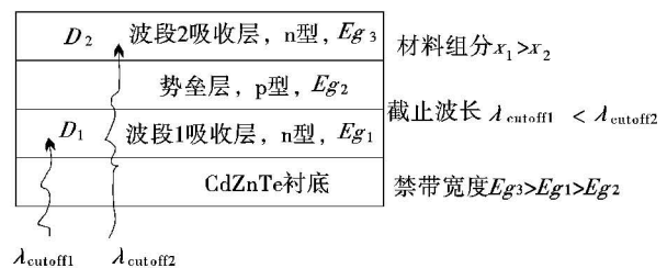
图 1 一个双色 MCT 光敏元的结构
