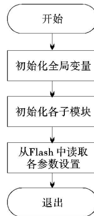
图 3 系统管理模块初始化程序流程图
