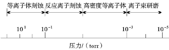
图3 不同干法刻蚀腔体的压力范围
