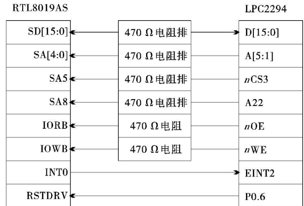
图 3 RTL8019AS 与 LPC2294 的接口连接示意图
