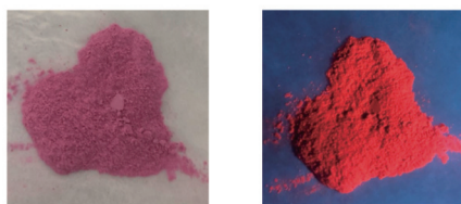
(b) 红色固态荧光 CQDs 在自然光下 (左) 和 365 nm 紫外灯照射下 (右) 的照片
