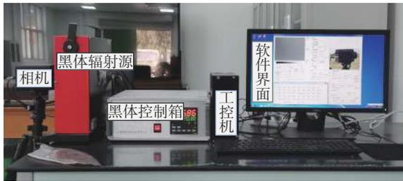
图 2 红外辐射特性测量系统实物图
