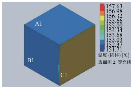
图 4 四个加热片时原子气室表面温度图
