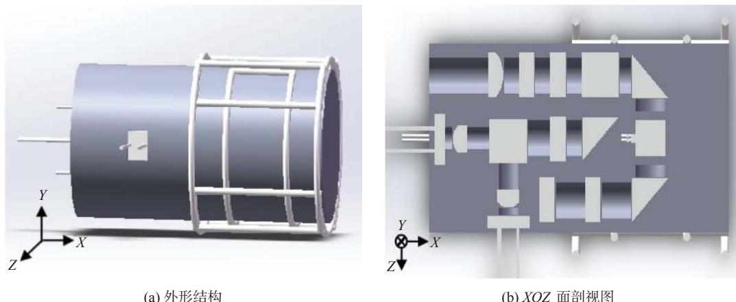
图 2 原子磁强计结构模型图
