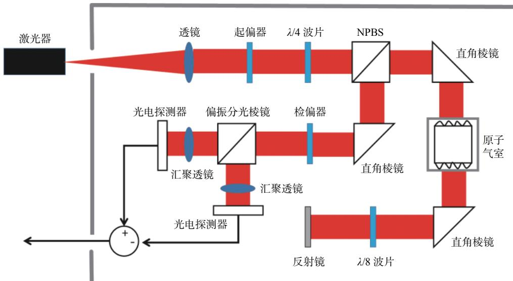
图 1 单光束原子磁强计光路设计图
