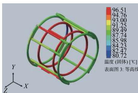
图 7 线圈结构温度分布图
