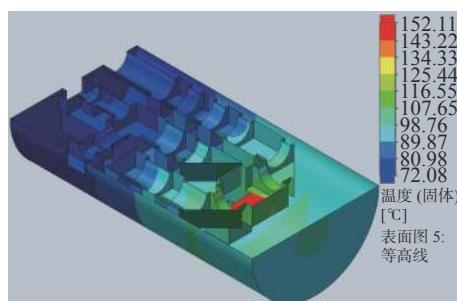
图 6 原子磁强计下壳体温度分布图
