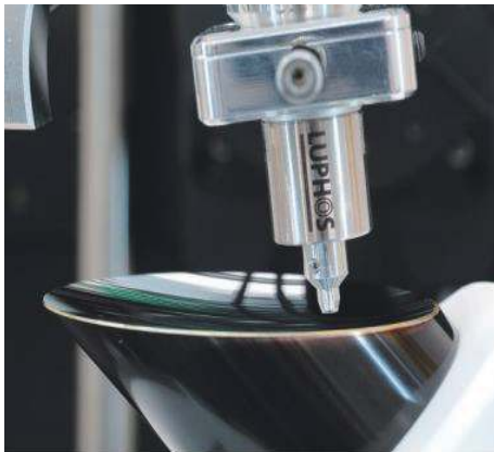
图 8 Lufoscan 测量离轴抛物面
