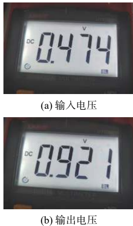
图 11 单级放大电路调试结果图
