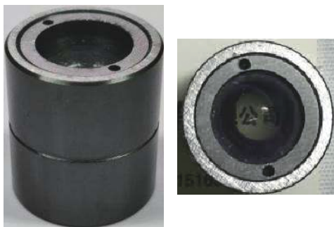
图 2 三液体透镜的实物示意图 Fig. 2 Photos of the three-liquid lens
