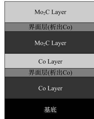
图 7 退火过程中 Co/Mo<sub>2</sub>C 多层膜的界面演化示意图
