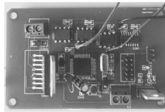
图 6 电磁防垢除垢电路实物
