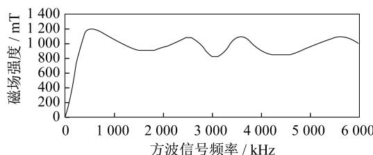
图 10 方波信号频率与磁感应强度关系
