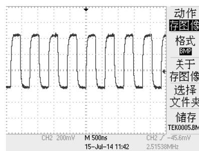
图 9 频率为 2.515 MHz 信号波形
