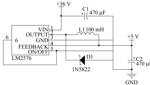
图 2 电源模块原理图
