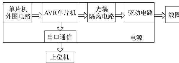
图 1 电磁除垢防垢系统原理框图
