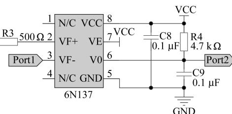
图4 光耦隔离电路
