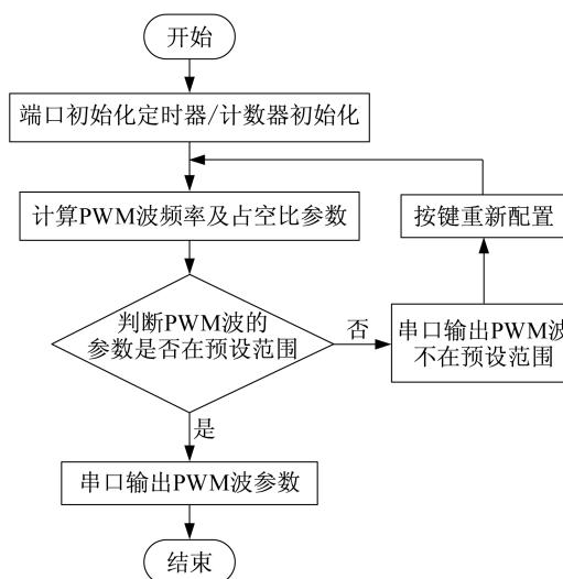
图 7 电磁防垢除垢电路程序流程图
