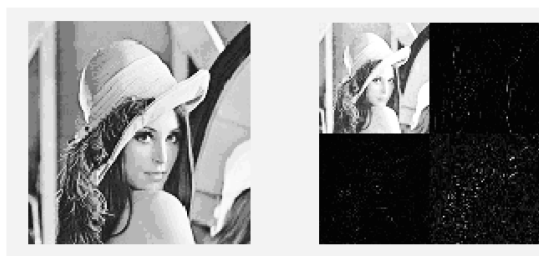
(a) 原始图像 (b) 小波变换后图像 (a) The original image (b) Wavelet transform of image
