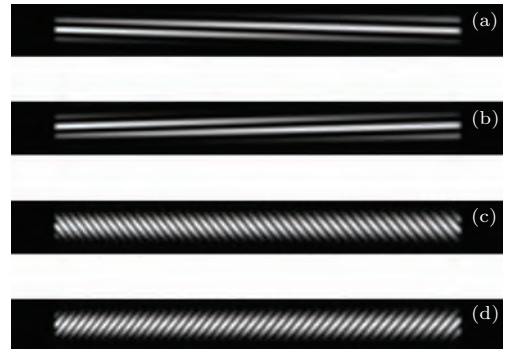
图 11 平移误差分别为 \pm 5 \mu\text{m} 和 \pm 200 \mu\text{m} 时的干涉条纹 (a) 平移误差 = 5 \mu\text{m} ; (b) 平移误差 = -5 \mu\text{m} ; (c) 平移误差 = 200 \mu\text{m} ; (d) 平移误差 = -200 \mu\text{m} Fig. 11. Dispersed fringes with piston error of 5 \mu\text{m} (a), -5 \mu\text{m} (b) and 200 \mu\text{m} (c), -200 \mu\text{m} (d).
