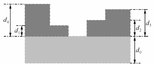
图 4 多台阶靶结构示意图 Fig. 4 Schematic configuration of multi-step target
