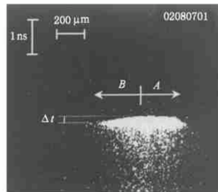
图 4 弯折靶背冲击发光信号
