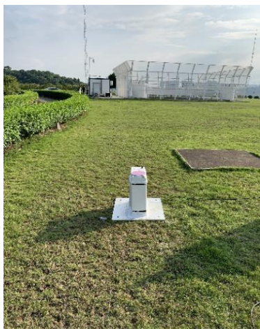
图5 广州市黄埔区相干测风激光雷达系统现场图
