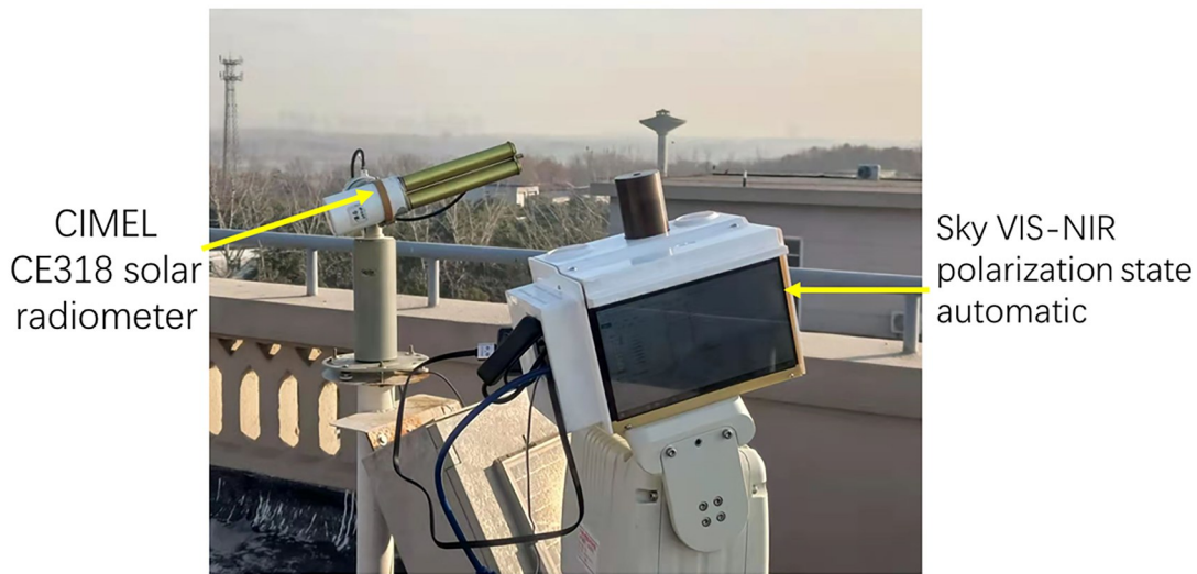
图 12 天空光偏振模式观测实验实拍图
