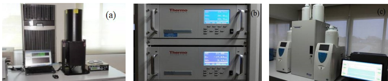
图1 微脉冲激光雷达(a)、TEOM 1400a在线监测仪(b)和URG-9000在线监测仪(c)
