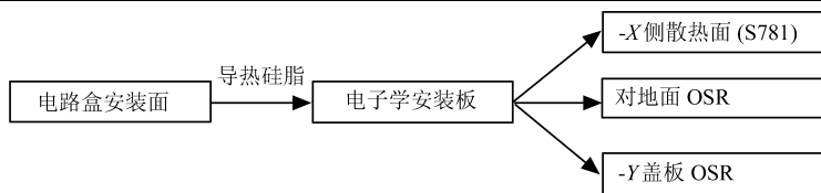
图 6 电子学箱散热路径示意图
