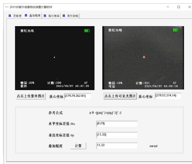
图 7 叠加精度测试图
