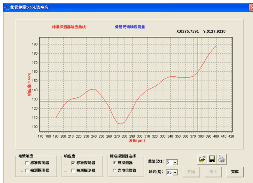
图 5 紫外像管的光谱响应曲线
