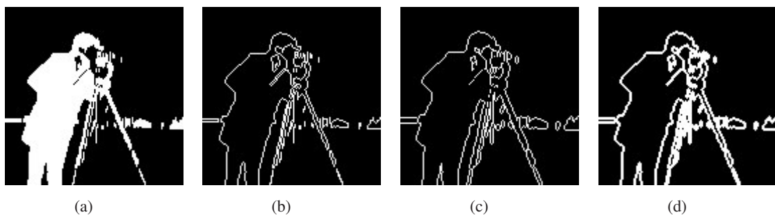
图 11 摄影师二值图像仿真结果图。(a)去噪处理结果图 F ; (b)腐蚀型边缘提取图 E_c ; (c)膨胀型边缘提取图 E_d ; (d)形态学梯度型边缘提取图 E_g
