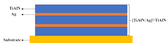
图4 双 Ag 型序构复合薄膜
