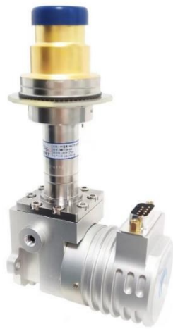
Fig. 5 MWIR detector with 1280×1024 10 \mu m HgCdTe FPA 图 5 1280×1024 10 \mu m 碲镉汞中波红外探测器
