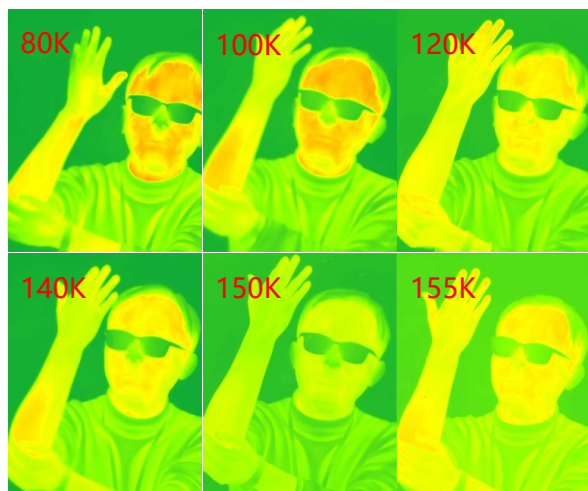
图10 320×256中波焦平面探测器在不同工作温度下的伪彩色成像图
