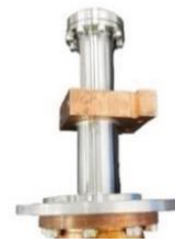
Fig. 3 Photo of 15 K second-stage pulse tube cryocooler 图3 第二级15 K脉管制冷机实物图
