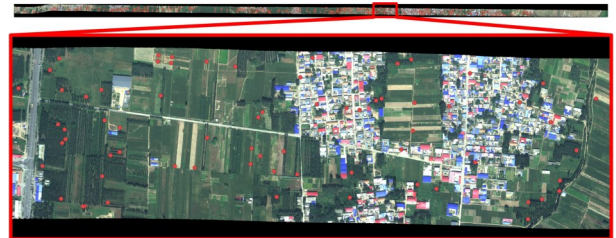
图 8 第 1 组相机可见近红外图像特征点分布及其局部放大图, 注: 红色点为特征点位置
