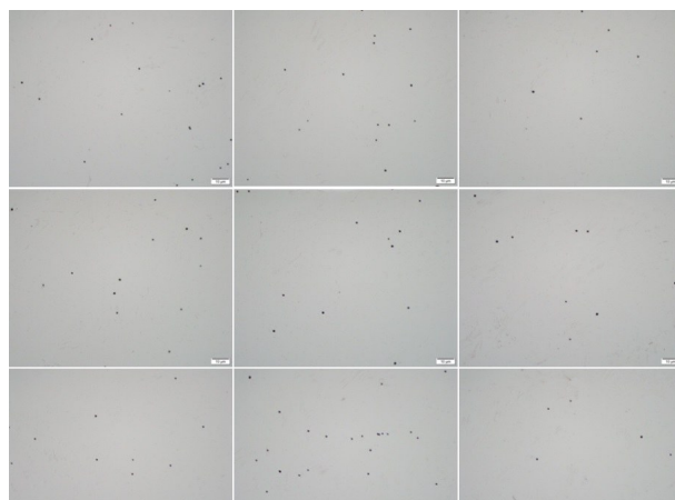
图8 中波/长波双色碲镉汞材料EPD测试结果(1000倍)
