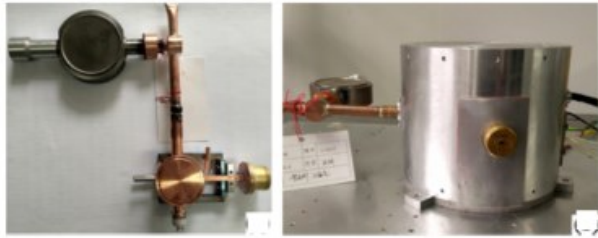
图 33 0.26 THz斜注管加工及装配情况 Fig. 33 Processing and assembly of 0.26 THz Clinotron
