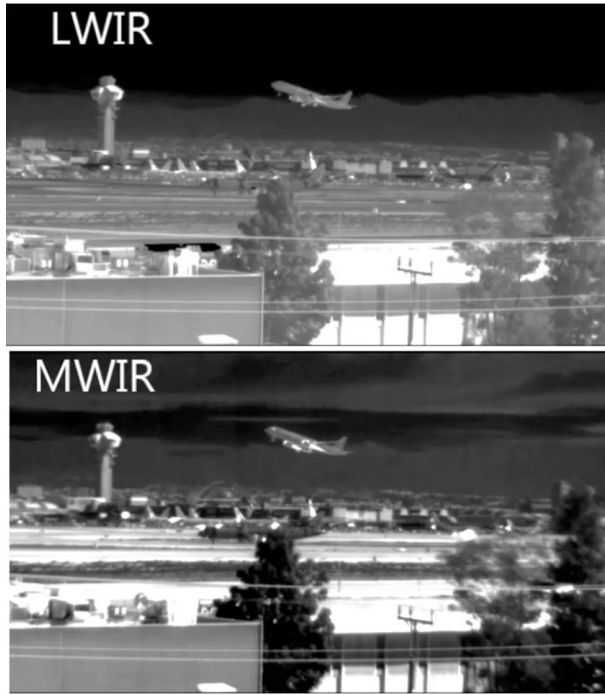
图2 HRL 制备的 1280×720 MW/LW 器件成像(上:长波成像,下:中波成像) [13]
