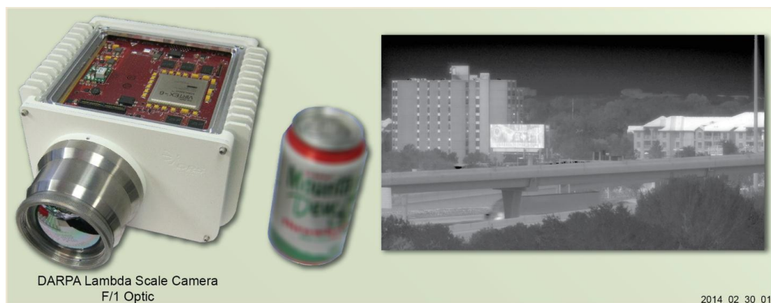
图 10 美国 DRS 公司波长 \lambda 尺度 1280×720 长波红外相机(F 数为 1)成像的照片 [68]
