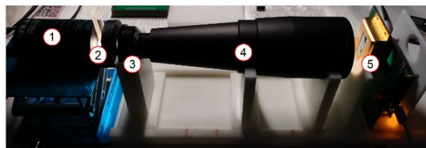
图6 实验平台示意图:1.光源,2.透射样本槽,3.标准稀土氧化物玻璃,4.扩束镜,5.光谱节点
